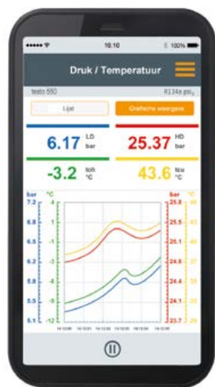
Avec l'appli Refrigeration, le testo 557 est connecté à une tablette pour l'enregistrement des mesures.
