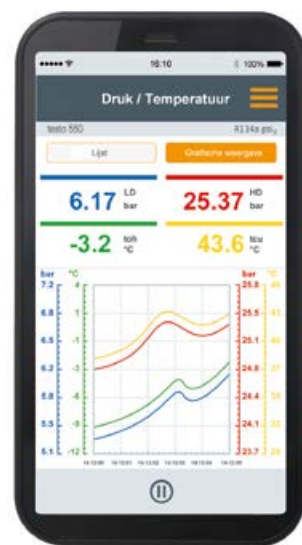
Met de Refrigeration-app wordt de testo 550 gekoppeld aan een tablet voor registratie van de meetwaarden.
