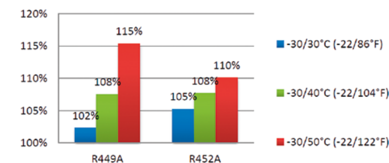
Graphique 5 : COP des R449A et R452A comparés au R404A pour les applications basses pressions d'évaporation.
