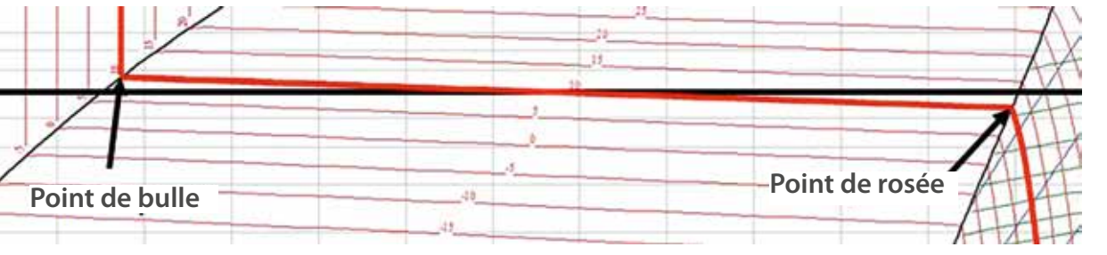
Figure 3 : Point de bulle et point de rosée.
