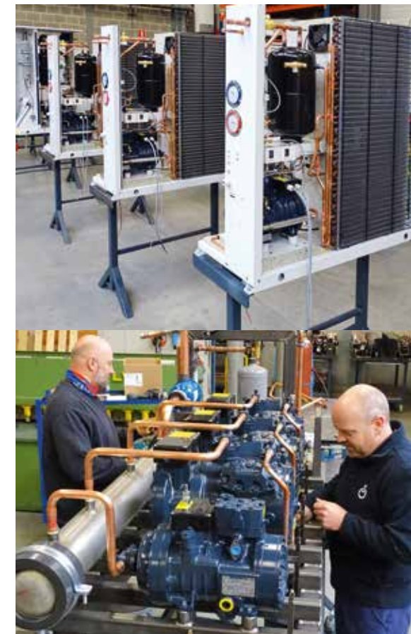
Bij Celsius Group in Houthalen worden koelcentrales, schakelkasten en condensingunits zoals de Pallas gemaakt.
