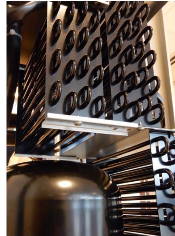
Le fonctionnement d'une boucle thermodynamique au CO 2 permet de recourir à un échangeur tubulaire, et donc de s'affranchir d'ajout de fluide et de se passer de filtre.
