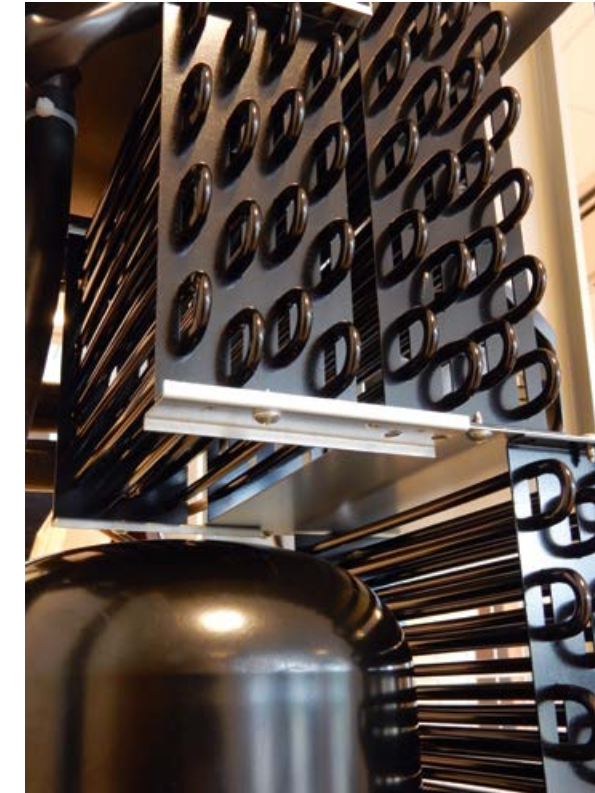
Dankzij de thermodynamische lus met CO 2 is het mogelijk een buisvormige warmtewisselaar te gebruiken, waardoor koelvinnen en een filter niet nodig zijn.
