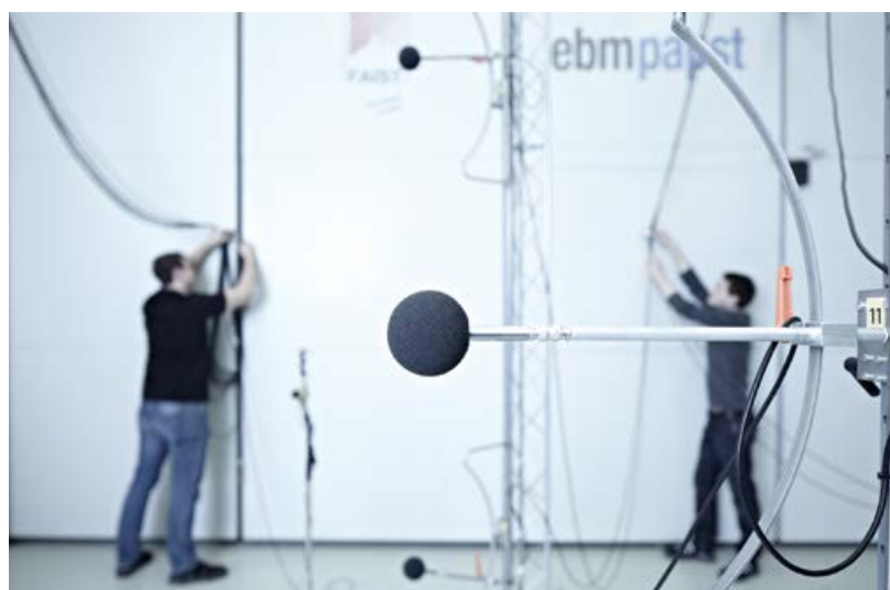
Illustration 5 : Des micros spécialement positionnés pour l'enregistrement des paramètres tant acoustiques que psychoacoustiques. (Photo: ebm-papst)
