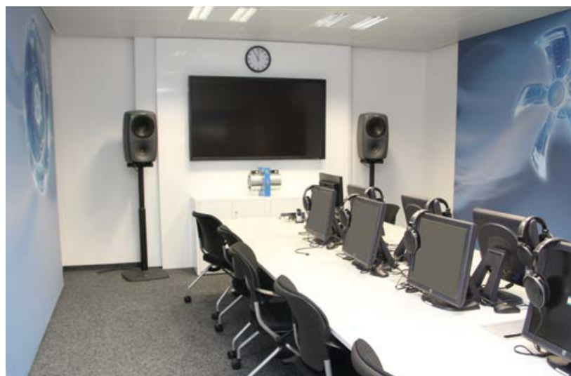
Illustration 4 : À la recherche de ventilateurs au bruit agréable. Il s'agit d'une pièce insonorisée pouvant accueillir jusqu'à huit participants chargés d'écouter le bruit émis par un ventilateur dans différentes configurations. (Photo: ebm-papst)
