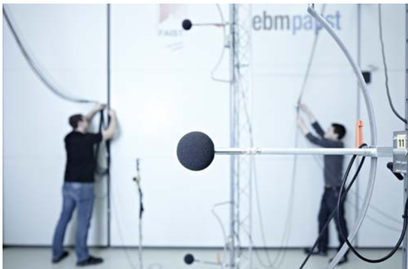
Afbeelding 5: Speciaal gepositioneerde microfoons voor het opnemen van zowel akoestische als psychoakoestische parameters. (Foto: ebm-papst)
