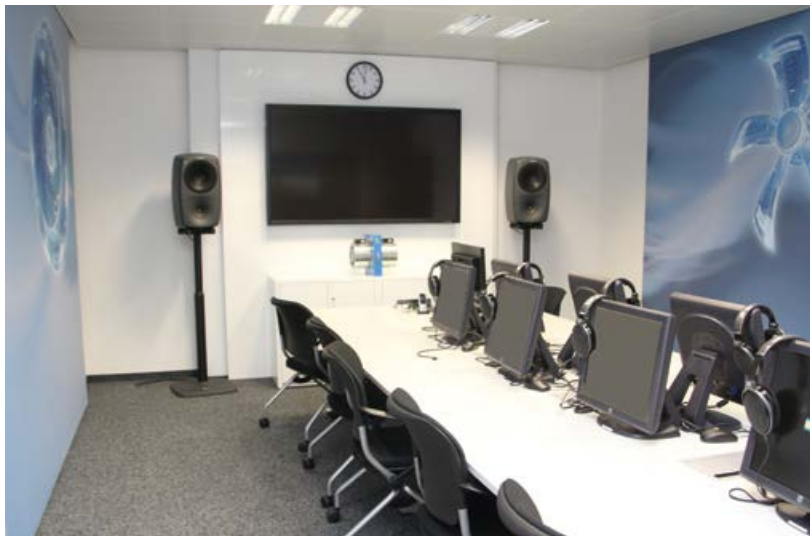
Afbeelding 4: Op zoek naar plezierig klinkende ventilatoren. Dit is een geluiddichte kamer voor maximaal acht proefpersonen die luisteren naar het geluid van een ventilator in verschillende configuraties. (Foto: ebm-papst)
